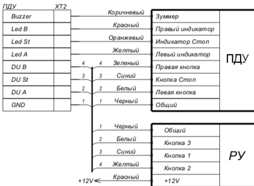
Рисунок 5. Схема подключений ПДУ или устройства РУ для вариантов конфигурации «Контроллер управления турникетом» и «Контроллер АТП»
